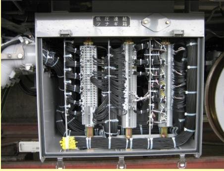
生产制造各种车上/车下用高低压电气配电箱。车下用电气配电箱采用完全防水的形式。近年来，WAGO端子台的采用比较普遍。
