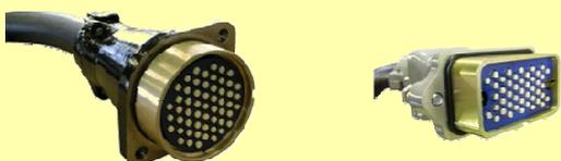
插针多采用对接接触式结构。芯数分别有27,48,55,63,76,96芯等形式，接续电线方面即可使用复合电缆也可采用单芯散线(安装在接线箱上的一种形式)。此外还有One-touch结构的12,19芯连接器。
