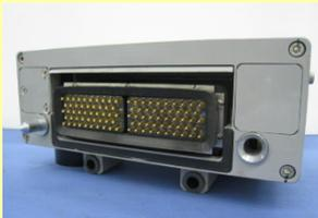
与铁路车辆用机械车钩相配套的一种主要形式的自动电气连接器。车辆连挂时，它与机械车钩分先后独立连接。在列车的机械车钩完成连挂后，再沿着导杆通过气缸的推动实现电气连接器的连接。
