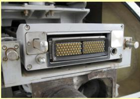
此种类型的自动电气连接器的本体与列车车钩的安装采用不完全固定形式(可相对摇动)。通过变形导杆使得列车在重连，车钩连挂过程中，自动电气连接器相对车钩有一定的摇动余量，同时通过导向杆寻找到与对面连接器相连接的位置，实施连接。这样可以保证自动电气连接器的电气回路的接续可靠性。此种类型的自动电气连接器广泛地应用于高速铁路车辆。
